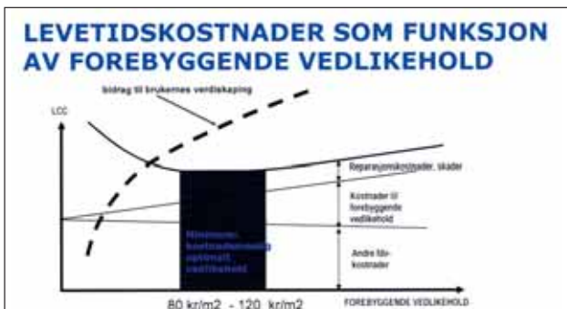
Planmessig, forebyggende vedlikehold vil redusere risikoen for uforutsette skader. Når det planmessige vedlikeholdet blir forsømt, øker skadeomfanget. Dersom også reparasjonsarbeidene forsømmes, øker skadeomfanget, og eiendommen får et aksellererende forfall
